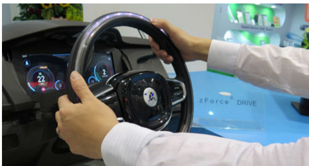
圖4 Neonode將觸控整合到汽車方向盤內，讓駕駛者可利用方向盤做出指令。
