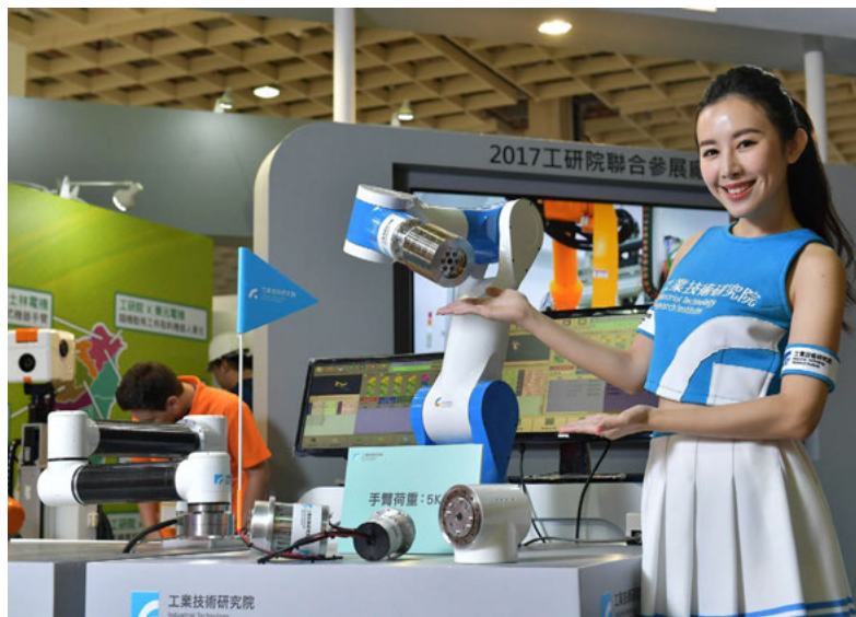
▲ 最新研發整合馬達、減速機、驅動電路的驅控整合關節模組，可大幅縮小機器手臂單元的空間。（圖片來源：工研院）
