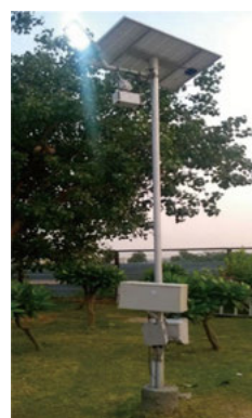
▲ 裝設在停車場的照明設備，內有意法半導體所開發的電路板。資料集中器單元（Data Concentrator Unit, DCU）附有機載的泛歐式數位行動通訊系統（GSM）模組，可以和使用通用封包無線電服務／第三代／第四代（GPRS/3G/4G）行動網路技術的雲端應用程式進行通訊。
