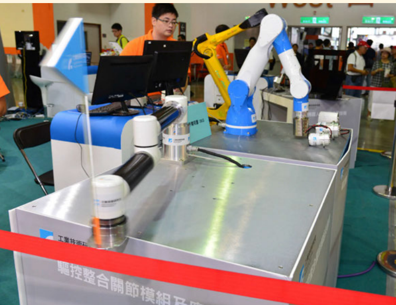
▲ 工研院6軸協作型、3-4軸SCARA兩款機器人依照不同構型展示其荷重能力及SCARA快速優勢。（攝影／陳念舜）
