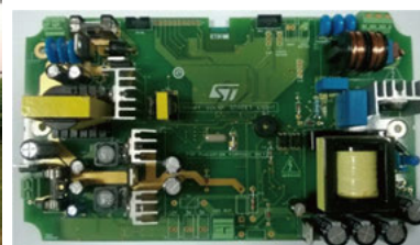
▲ 裝設在停車場的照明設備，內有意法半導體所開發的電路板。資料集中器單元（Data Concentrator Unit, DCU）附有機載的泛歐式數位行動通訊系統（GSM）模組，可以和使用通用封包無線電服務／第三代／第四代（GPRS/3G/4G）行動網路技術的雲端應用程式進行通訊。
