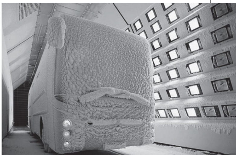
▲ 在阿森納爾鐵路技術試驗中心氣候風洞內的結冰巴士 (source : © RTA)
