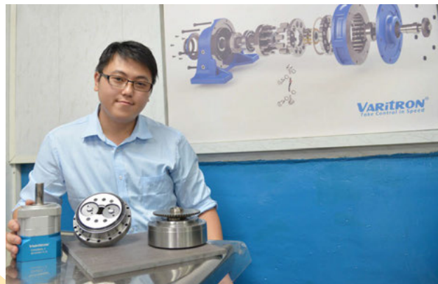
▲ 中國變速工程公司何俊宏看好RV減速機比起HD減速機，更適用於追求結構緊湊，又要兼顧低背隙精密、輸出大扭矩需求等更多客戶的不同使用習慣。（攝影／陳念舜）
