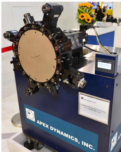
▲ 與自主開發的「單馬達動力刀塔」組成完善產品線，現也安裝在自家加工廠的CNC工具機上，相信能協助客戶生產更好產品。（攝影／陳念舜）
