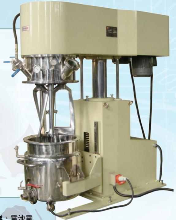
油漆、油墨、化學工業用、IC產業塗料造製、電子產業、電子FPC電路產業、電池電漿、藥膏、乳膏及化妝品等高分子化學塗料的均質攪拌及細度研磨。
