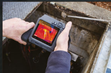
可以180度旋轉的鏡頭模組，搭配明亮高密度4吋電容式觸控面板，在各種環境中都方便操作FLIR T500
