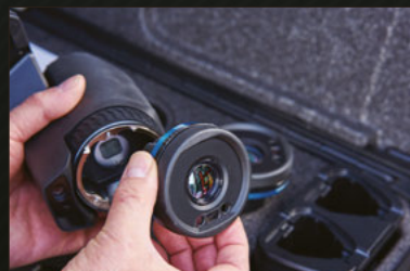
歸功於AutoCal TM 智慧型鏡頭，可以直接在不同台像機之間交換使用。
