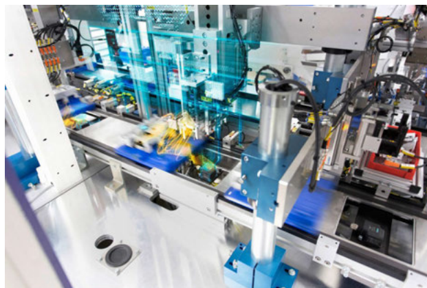
▲ 導入RFID的目的，是透過系統讓製程可視化，從而解決生產瓶頸與良率問題。（source：Siemens）
