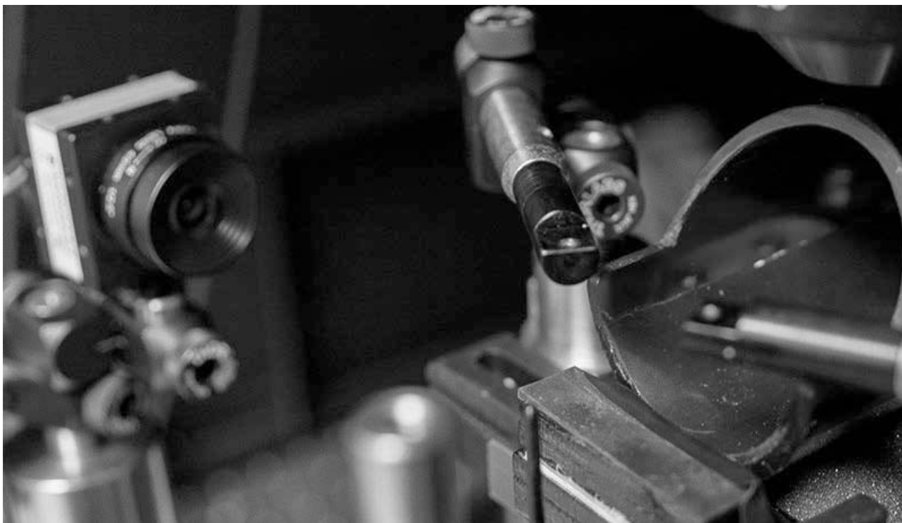
▲ DeepLabCut裝備兩台DMK 37 BUX287相機以捕捉高速錄影，並藉由其影像幀數進行無標記3D姿態擷取。（source：Cassandra Krios）
