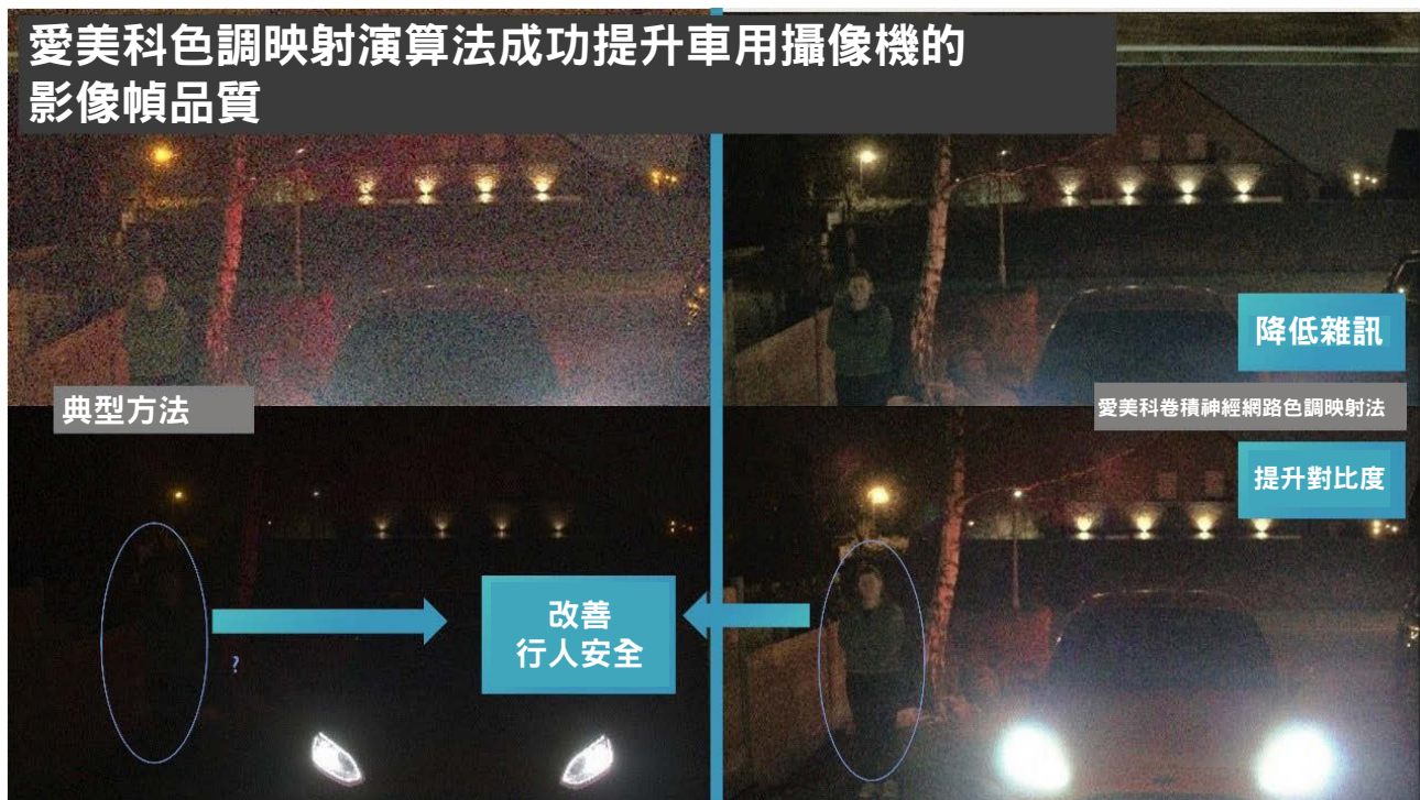
▲ 圖五：評估愛美科的自動化色調映射技術：根特大學研究人員版本（右圖）以及現有色調映射軟體版本（左圖）。（source：imec）
