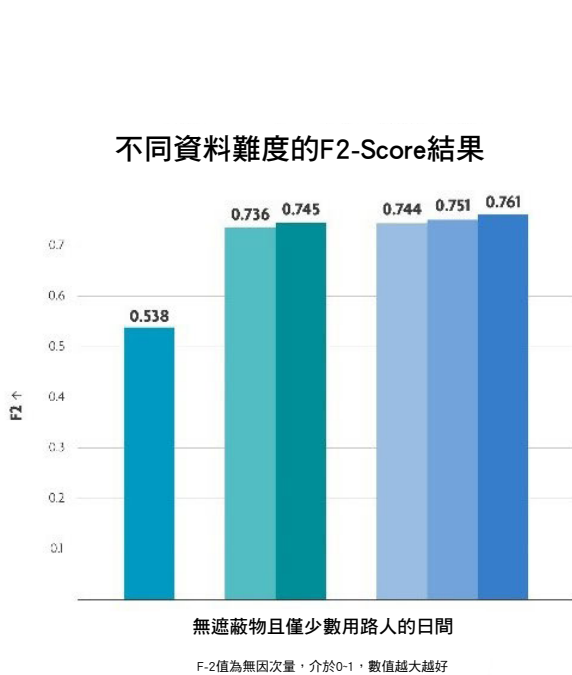
▲ 圖三：比較不同行人偵測方法測得的F2-Score，包含簡易情境（左圖）與嚴峻情況（右圖）。F2-Score可以客觀地測量系統準確度，權重聚焦在未命中率（假陰性）。在兩種情境中，合作式雷達與影像感測器融合的效能表現皆勝過單純使用攝影機和晚期融合的競爭方法。（source：imec）
