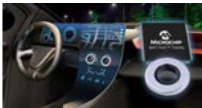
Microchip推出基於maXTouch技術的顯示幕旋鈕（KoD）控制器，這是首款原生即支援電容式旋轉編碼器之偵測和報告的車用級，觸控式螢幕控制器系列產品，同時也支援觸摸面板頂部的機械開關。與傳統機械式旋轉編碼器不同，這項新技術可將旋鈕直接安裝在顯示幕上，無需在面板上開孔或對觸摸模式進行任何客製，因而提高了設計靈活性並節省了系統成本。KoD技術消除了對客製化觸摸感測器模式的需求，使設計人員能夠輕鬆實現不同的旋鈕數量、形狀和位置，以適應各種終端使用者產品。客製化配置可在不改變maXTouch KoD觸摸控制器的嵌入式韌體的情況下進行調整，使開發週期更快、更靈活。
